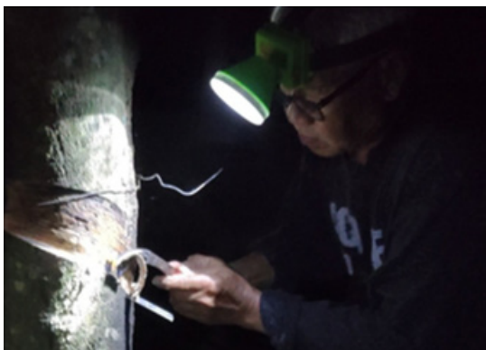
ภาพที่ 1 การทดลองนำถ้วยรองรับน้ำยางที่ตัดแปรรูปพื้นผิวไปใช้งานจริงในสวนยาง
