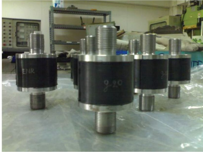
รูปที่ 2 แบริ่งยางขนาดเล็กสำหรับทดสอบการสั่นสะเทือน
