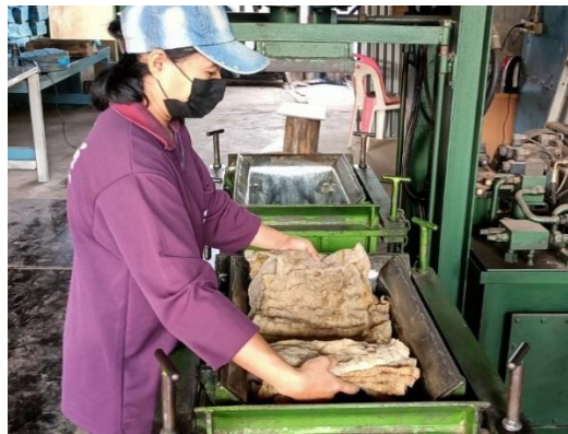
ภาพที่ ก.5 การอัดแท่งยางเครปบางสีน้ำตาลเกรดพรีเมียม
