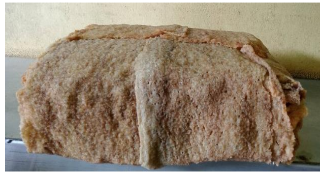
ภาพที่ ก.3 การพับปลายยางเครปบางสีน้ำตาลเกรดพรีเมียมและยางเครปบางสีน้ำตาลเกรดพรีเมียมที่ห่อด้วยแผ่นยาง
