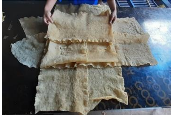
ภาพที่ ก.2 การพับยางเครปบางสีน้ำตาลเกรดพรีเมียมแต่ละแผ่นที่มีความกว้างและยาวใกล้เคียงกับพื้นที่หน้าตัดของแผ่นท่อที่ซ้อนทับกัน และเรียงสลับกัน
