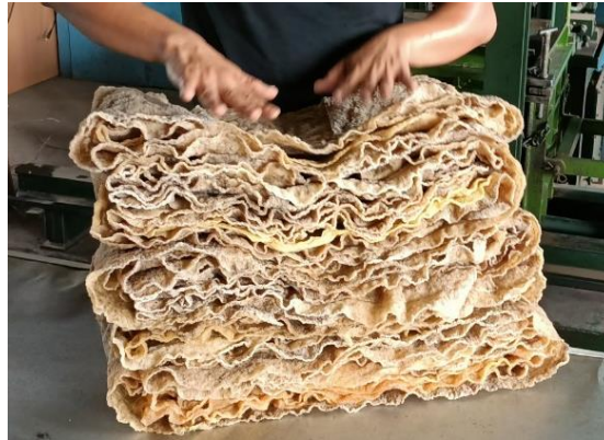
ภาพที่ ก.4 ยางเครปบางสีน้ำตาลเกรดพรีเมียมที่พับแล้ว
