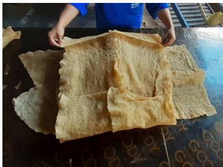
ภาพที่ ก.3 การพับปลายยางเครปบางสีน้ำตาลเกรดพรีเมียมและยางเครปบางสีน้ำตาลเกรดพรีเมียมที่ห่อด้วยแผ่นยาง
