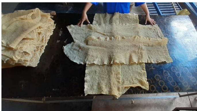
ภาพที่ ก.1 การวางยางเครปบางสีน้ำตาลเกรดพรีเมียม
