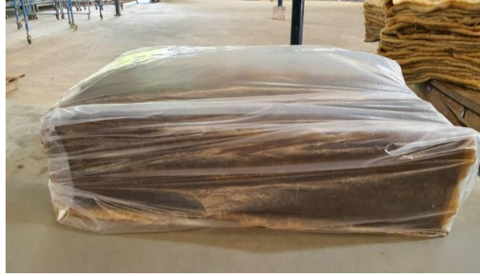
ภาพที่ ก.6 ยางเครปบางสีน้ำตาลเกรดพรีเมียมแบบอัดแท่งในถุงพลาสติกที่ปิดสนิท
