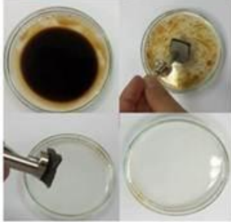
การดูดซับน้ำมันที่อยู่บนผิวของโพลีเมอร์ที่มีอนุภาคนาโนของเหล็กออกไซด์
