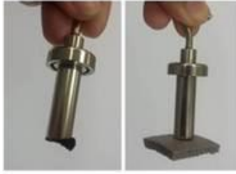
รูปอนุภาคนาโนของเหล็กออกไซด์และโพลีเมอร์ที่มีอนุภาคนาโนของเหล็กออกไซด์ที่ติดติดกับแม่เหล็ก
