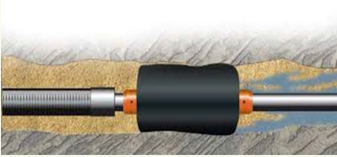
รูปที่ 2 ตัวอย่างการนำยางพองน้ำมาผลิตท่อ Freecap ใช้งานแทนที่ปูนซีเมนต์
