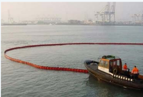
รูปที่ 1 ตัวอย่างทุ่นแนวกั้นน้ำมัน
