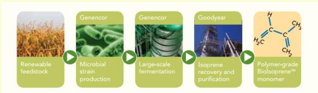
รูปที่ 1 กระบวนการผลิตไบโอไอโซพรีนของบริษัท Goodyear และบริษัท Genencor
