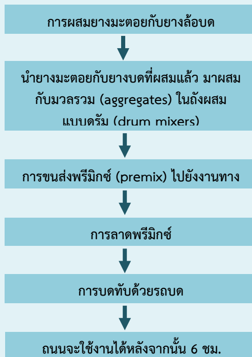
รูปที่ 2 กระบวนการผลิตยางมะตอยผสมยางบดรีไซเคิล
