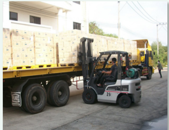
รูปที่ 6 การทดลองใช้งานยางล้อต้นจริงกับ รถฟอร์คลิฟท์
