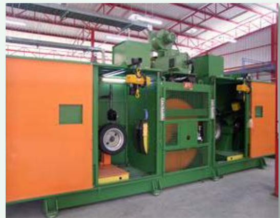
รูปที่ 4 เครื่องทดสอบยางล้อวัดสัมประสิทธิ์ความต้านทานต่อการหมุน
