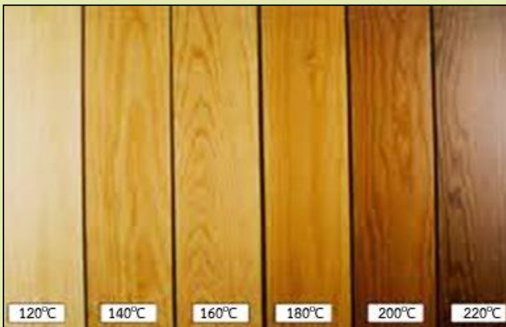
รูปที่ 2 การเปลี่ยนสีไม้เมื่อทำเทอร์โมวูด
