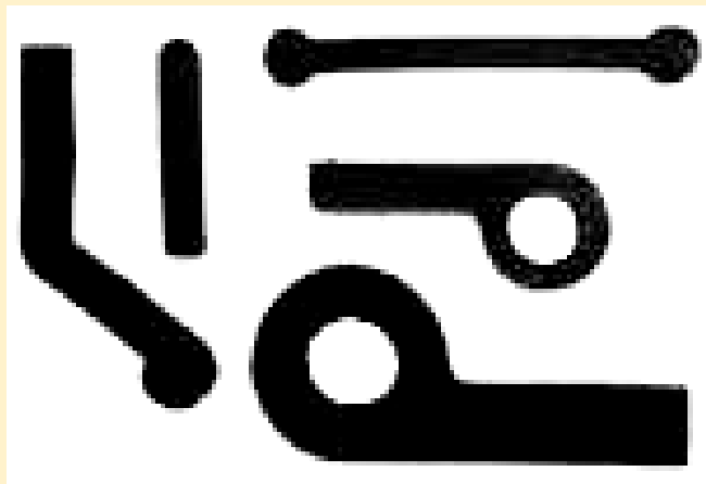
รูปที่ 1 ลักษณะหน้าตัดของแผ่นยางกันน้ำซึมแบบต่างๆ
