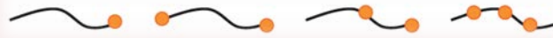
รูปที่ 2 พอลิเมอร์ที่มีหมู่ฟังก์ชันเหมือนกันแต่ตำแหน่งบนสายโซ่หลักแตกต่างกัน [1]
