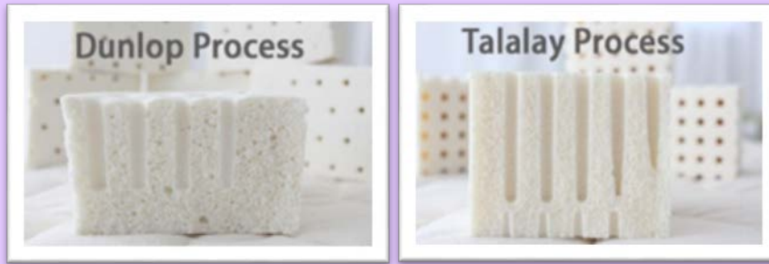
รูปที่ 3 ลักษณะโฟมยางวิธีดันลอปและโฟมยางวิธีทาลาเลย์ [4]
