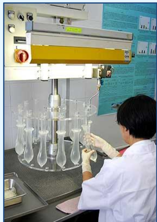
รูปที่ 3 การทดสอบการรั่วซึมของถุงยางอนามัย [13]
