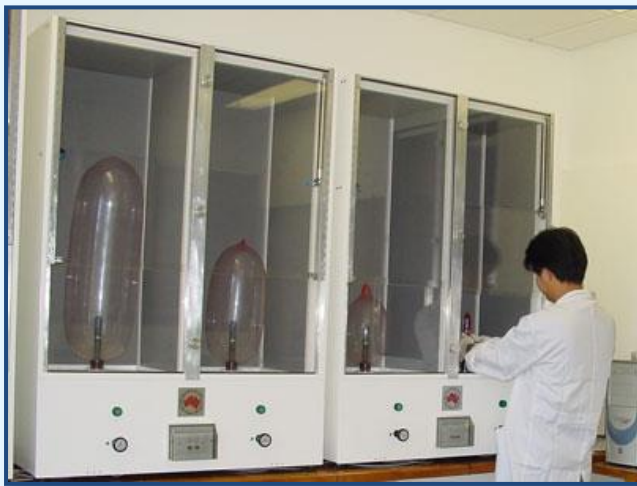
รูปที่ 2 การทดสอบปริมาตรและความดันขณะแตก [12]
