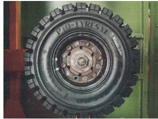
ต้นแบบยางล้อตันรุ่น PIO-TYRES XL ขนาด 7.00-12/5.00 136 A5 Solid
