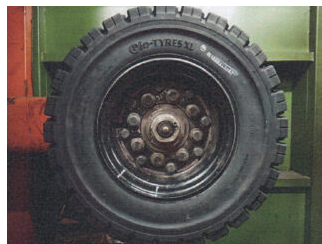
ต้นแบบยางล้อตันรุ่น PIO-TYRES XL ขนาด 6.00-9/4.00 121 A5 Solid
