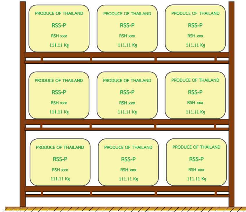
ภาพที่ ก.19 การจัดวางยางแผ่นรมควันเกรดพรีเมียมแบบอัดก้อนบนชั้นแผงเหล็ก
