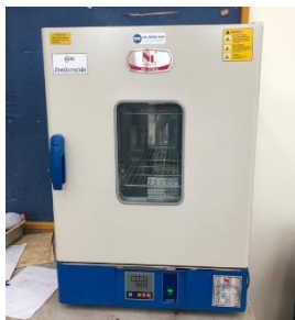
รูปที่ 6 ตู้ควบคุมอุณหภูมิ
