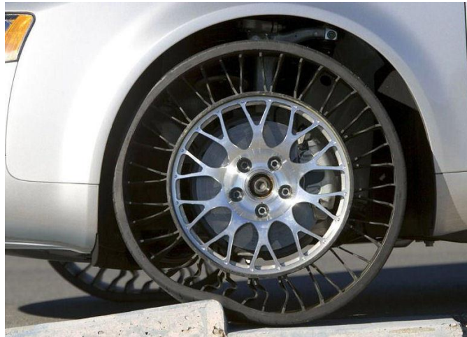
รูปที่ 2 ยางล้อ Tweel ของบริษัท Michelin
