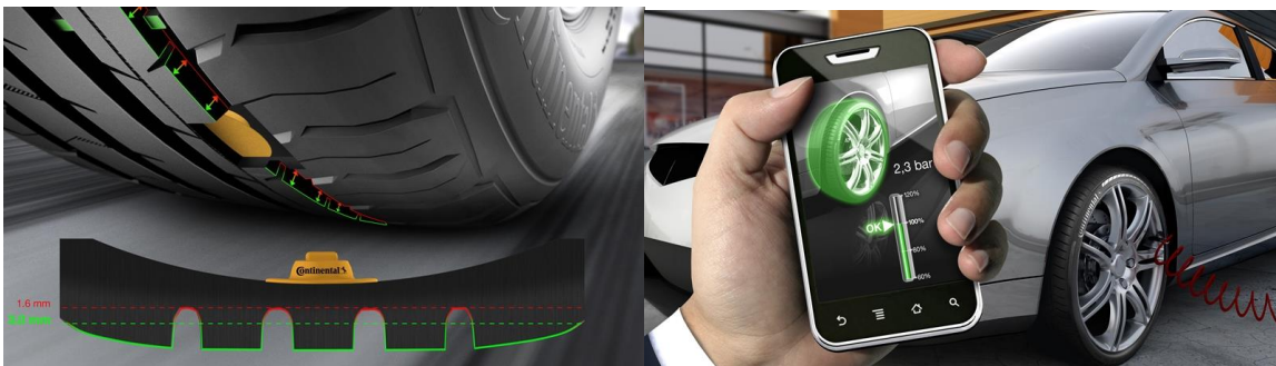
รูปที่ 3 การทำงานระหว่างเซ็นเซอร์กับยางล้อของบริษัท Continental [5]
