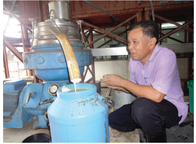
ภาพที่ 6 น้ำยางข้นที่ผลิตได้ปราศจาก TMTD/ZnO
