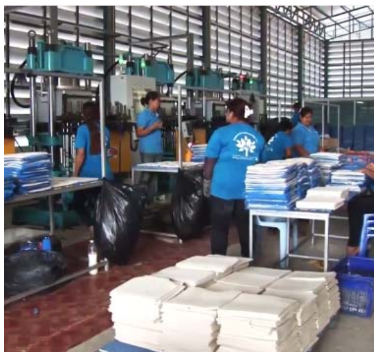
รูปที่ 7 การขึ้นรูปแผ่นยางปูสนามฟุตบอลด้วยแม่พิมพ์
