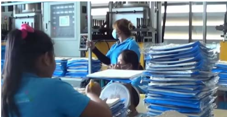
รูปที่ 6 การนำหน้ากและประกบยางคอมพาวด์ก่อนการขึ้นรูป
