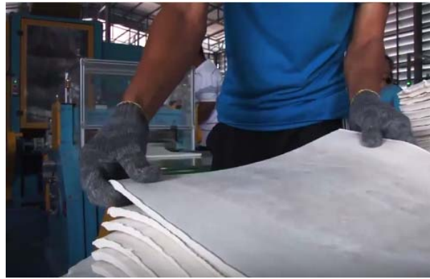
รูปที่ 5 การรีดแผ่นยางและตัดตามขนาด
