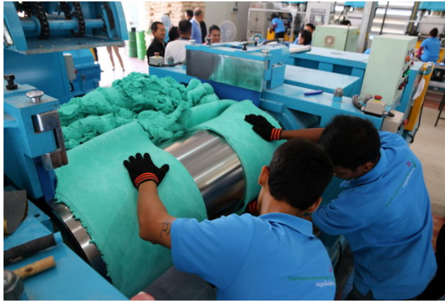
รูปที่ 4 การผสมยางคอมพาวด์
