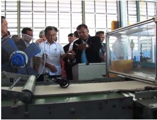
รูปที่ 5 การรีดแผ่นยางและตัดตามขนาด
