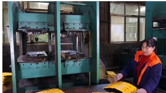
รูปที่ 3 การขึ้นรูปยางชะลอความเร็วด้วยแม่พิมพ์
