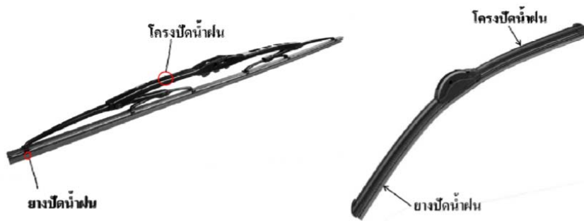
รูปที่ 1 ตัวอย่างยางปัดน้ำฝนที่ประกอบกับโครงปัดน้ำฝน
