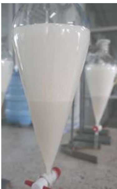
รูปที่ 3 การแยกชั้นของน้ํายางข้นชนิดครีม
