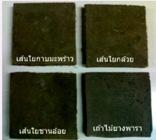
รูปที่ 1 ฉนวนจากเส้นใยกล้วยพาราเสริมแรงด้วยเส้นใยธรรมชาติ
