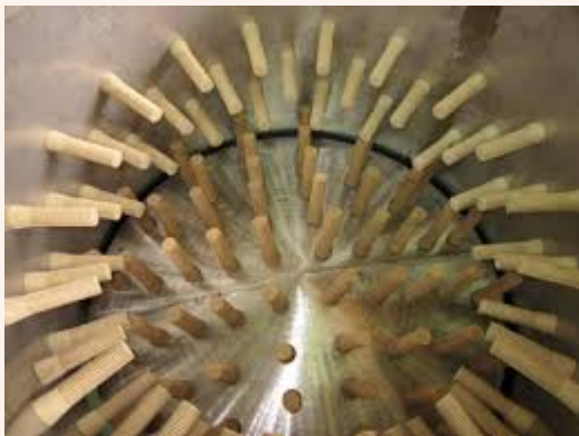
(ก) เครื่องถอนขนไก่แบบติดตั้งในถังกลม
