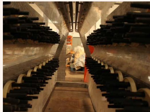
(ข) เครื่องถอนขนไก่แบบติดตั้งกับผนังห้อง
