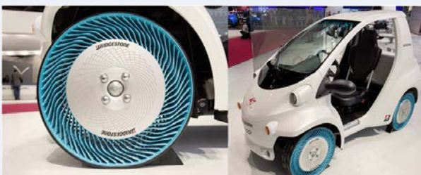
ยางล้อไร้ลมของ Bridgestone จัดแสดงในงาน Paris Auto Show 2014
