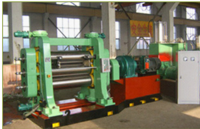
รูปที่ 5 เครื่องคาลเ็นเดอร์ (calender) [8]
