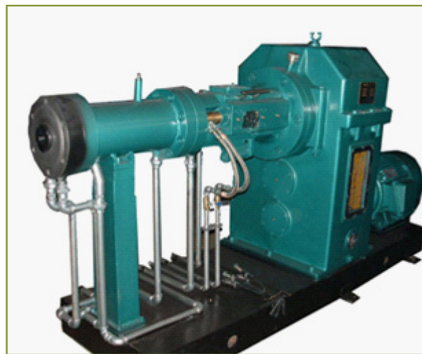
รูปที่ 4 เครื่องเอ็กสทรูดที่อาศัยแรงอัดจากการหมุนของเกลียวหนอน (screw extruder) [7]
