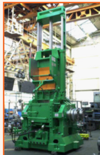
รูปที่ 2 เครื่องผสมระบบปิดแบบนบุรี (Banbury internal mixer) [5]
