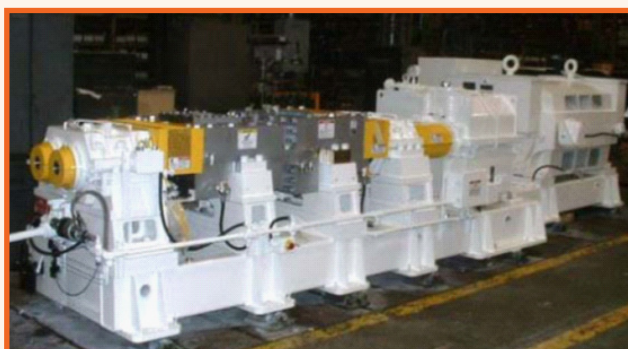
รูปที่ 6 เครื่องผสมยางแบบต่อเนื่อง (continuous mixer) [9]
