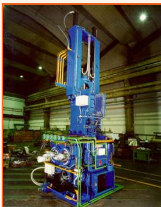
รูปที่ 4 เครื่องผสมยางระบบปิดแบบที่ปรับระยะห่างระหว่างโรเตอร์ได้ (variable intermeshing clearance internal mixer) [7]
