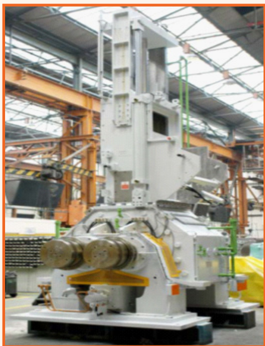
รูปที่ 3 เครื่องผสมยางระบบปิดแบบอินเตอร์มิกซ์ (Intermix internal mixer) [6]
