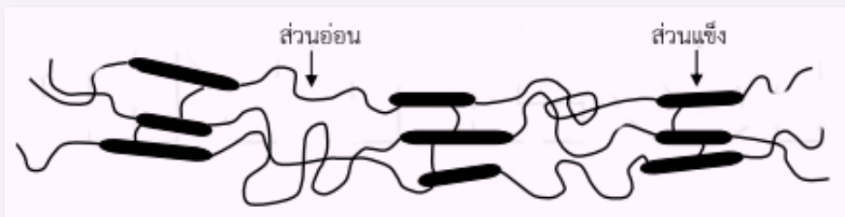
รูปที่ 1 โครงสร้างโมเลกุลของยางเทอร์โมพลาสติกแบบบล็อกโคพอลิเมอร์
