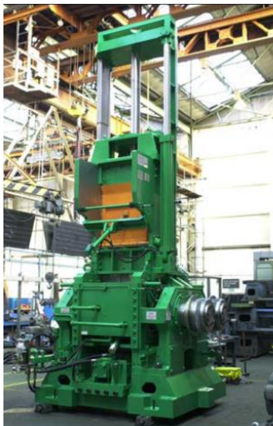
รูปที่ 2 เครื่องผสมระบบปิดแบบบูรี (Banbury internal mixer) [7]
