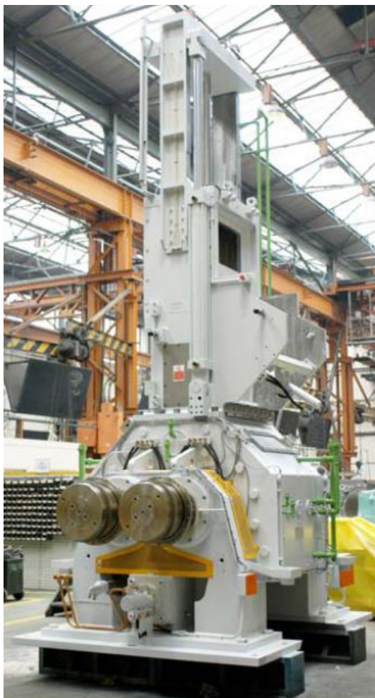
รูปที่ 3 เครื่องผสมยางระบบปิดแบบอินเตอร์มิกซ์ (Intermix internal mixer) [8]
