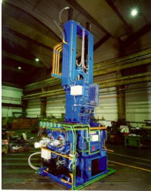
รูปที่ 4 เครื่องผสมยางระบบปิดแบบที่ปรับระยะห่างระหว่างโรเตอร์ได้ (variable intermeshing clearance internal mixer)
