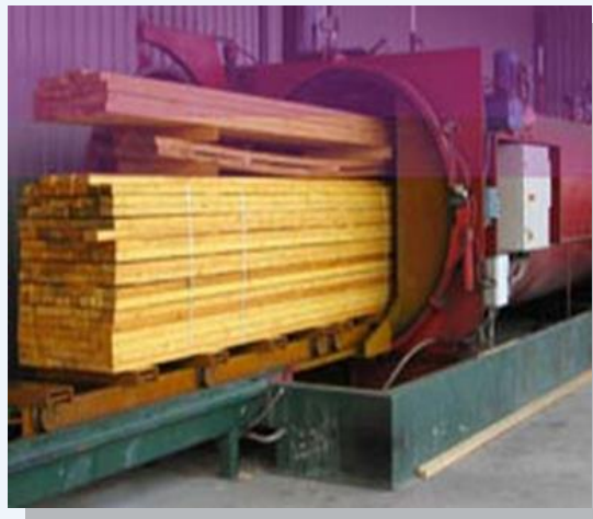
รูปที่ 2 การนำไม้เข้าเครื่องอัดน้ำยา
