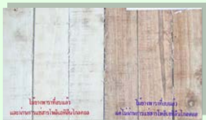
รูปที่ 2 สีของไม้ยางพาราที่ผ่านและไม่ผ่านการแช่ PEG 1000 หลังการอบ
